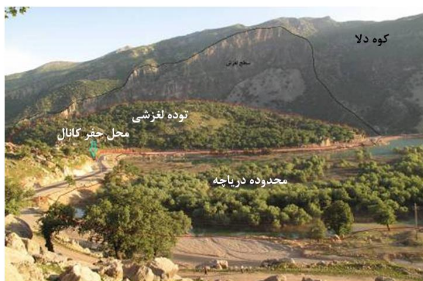
شکل (۲). سطح لغزش، توده لغزشی و دریاچه سدی شیمبار
