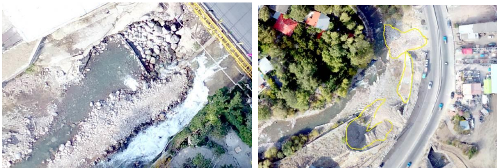
شکل (۸). وقوع حرکات توده‌ای در کناره رود در بازه ۳ شکل (۹). سنگ‌چین و ایجاد تندآب‌های مصنوعی در بازه ۳
