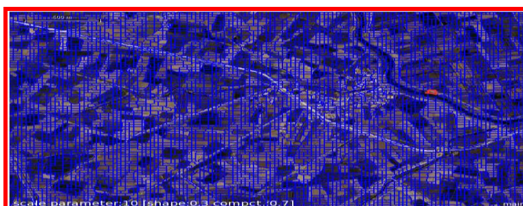
مقیاس ۱۰، ضریب شکل ۰/۳، فشردگی ۰/۷ شکل (۲). نمایش تصویر اصلی و سگمنت سازی در مقیاس، ضریب شکل و فشردگی مختلف (منبع: نگارندگان)
