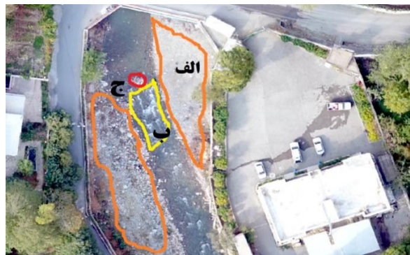
شکل (۵). الف. رسوب‌گذاری در کنار رود. ب. خیزآب‌ها ج. وجود موانع چوب در درون کانال در بازه ۲
