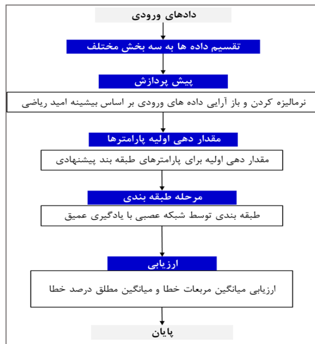
شکل (۲). ارائه راهکار پیشنهادی در پیش‌بینی وقوع شرایط آسایش حرارتی انسان به صورت هوشمند
