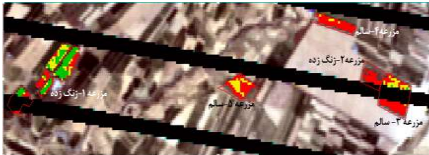
شکل (۵). تصویر حاصل از طبقه‌بندی با استفاده از مدل WHI در تاریخ ۱۳۹۳/۱/۱۷. رنگ‌های سبز، زرد و قرمز در تصویر به ترتیب نشان‌دهنده پیکسل‌های سالم، مشکوک و ناسالم می‌باشند.
